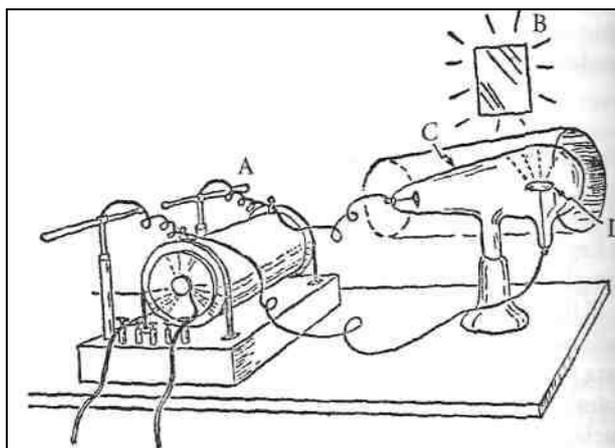
Fig. 21. El aparato de rayos X utilizado por Rontgen consistía en: (A) bobina inductora de alto voltaje; (B) papel pintado con platino-cianuro bórico, que resplandecía al ser alcanzado por los rayos; (C) tubo rodeado por una envoltura cilíndrica de cartón negro; (D) el cátodo, que emitía electrones.
