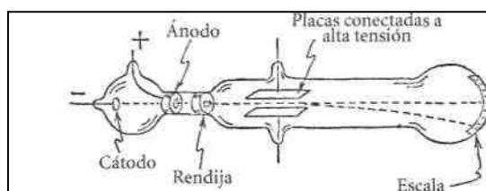
Fig. 20. El tubo de rayos catódicos permitió a Thomson medir la desviación de los haces electrónicos en campos eléctricos de intensidad conocida. El haz pasaba entre las placas, cuyo campo desviaba a los electrones, desplazando sus puntos de choque a lo largo de la escala.
