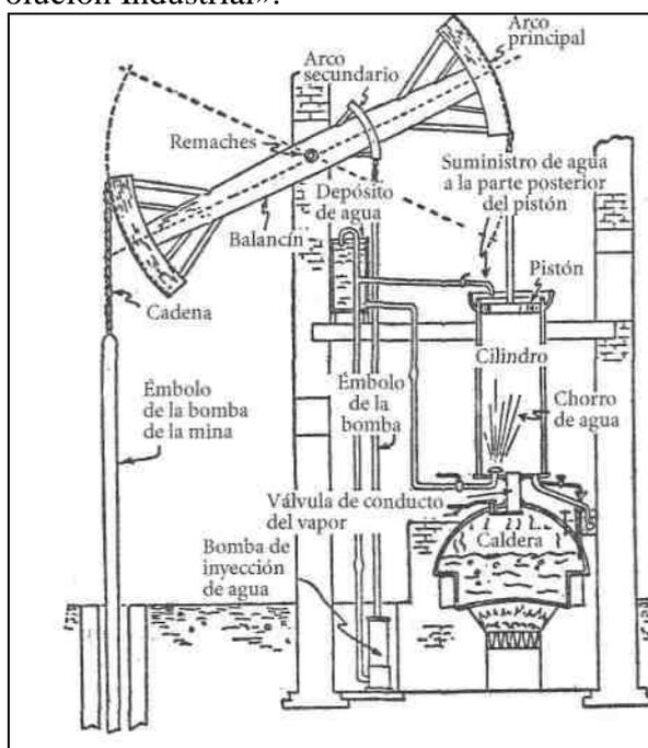
Fig. 5. La máquina de bombeo de Newcomen, que funciona a presión atmosférica. El agua pulverizada en el interior del cilindro condensa el vapor, creado un vacío. El pistón desciende en el vacío, para volver hasta arriba del émbolo por una nueva inyección de vapor.
