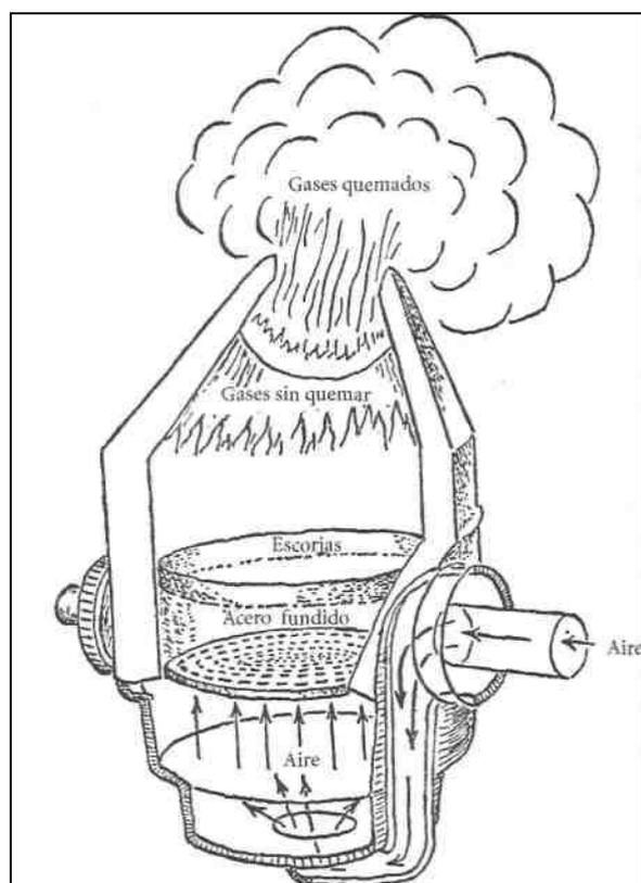
Fig. 19. El convertidor de Bessemer revolucionó la producción de acero.
